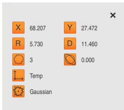
Рисунок 27: Предварительный просмотр измерения для окружности
