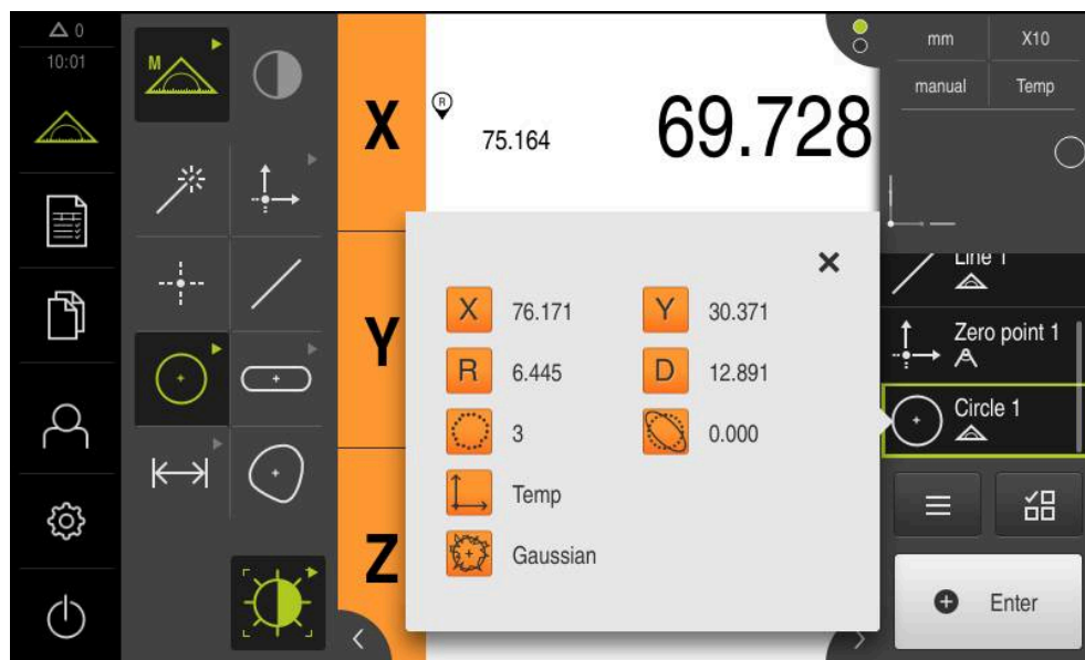
Рисунок 57: Элемент Окружность с Предварительный просмотр измерения при записи точек измерения с использованием активного измерительного инструмента OED
